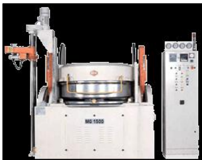
Slika 7, Presa za toplo protektiranje /1/
