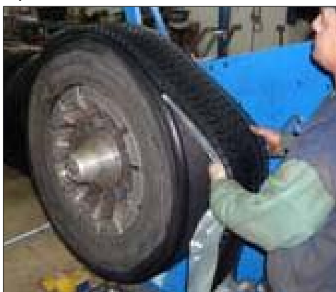
Slika 8. Postavljanje protektora u vidu trake /1/
